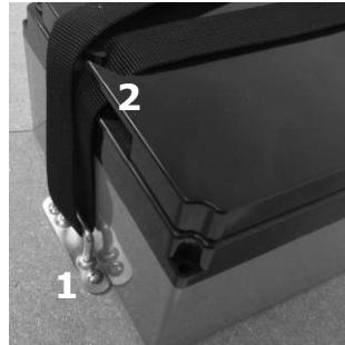
Die Plus- und Minus-Kabel werden an den Batteriepolen mit den beigefügten M8 Ringen und -Schrauben befestigt. Die Kabelanschlüsse am Batterie müssen durch die mitgelieferten Isolerkappen aus Gummi geschützt werden.
